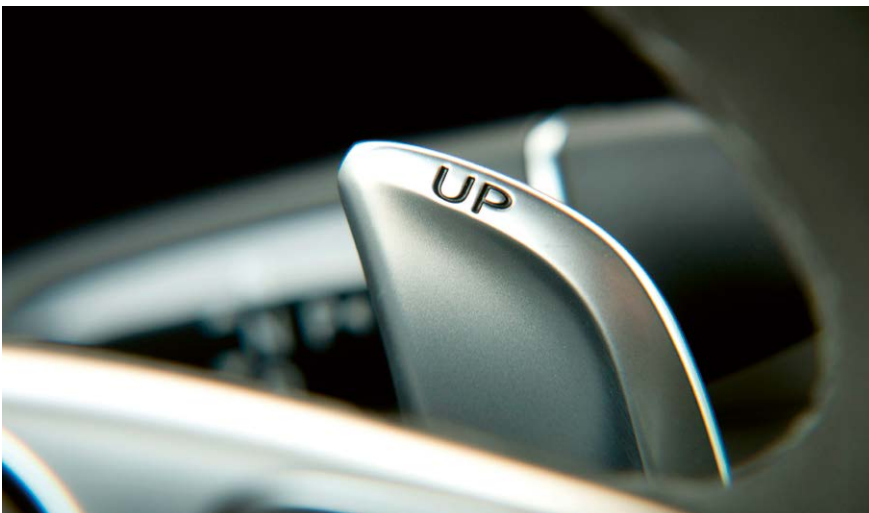
↑ В ручном режиме работы трансмиссии 9G-Tronic передачи можно переключать подрулевыми лепестками
